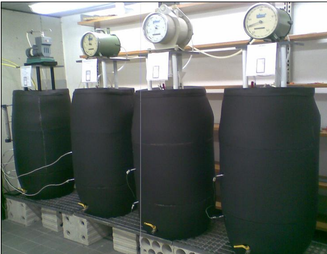
Abbildung 3 Die vier Fass-Lysimeter vor und nach thermischer Isolation
